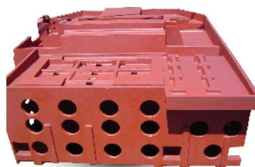
機械零件-銑床機底座±2100kg
